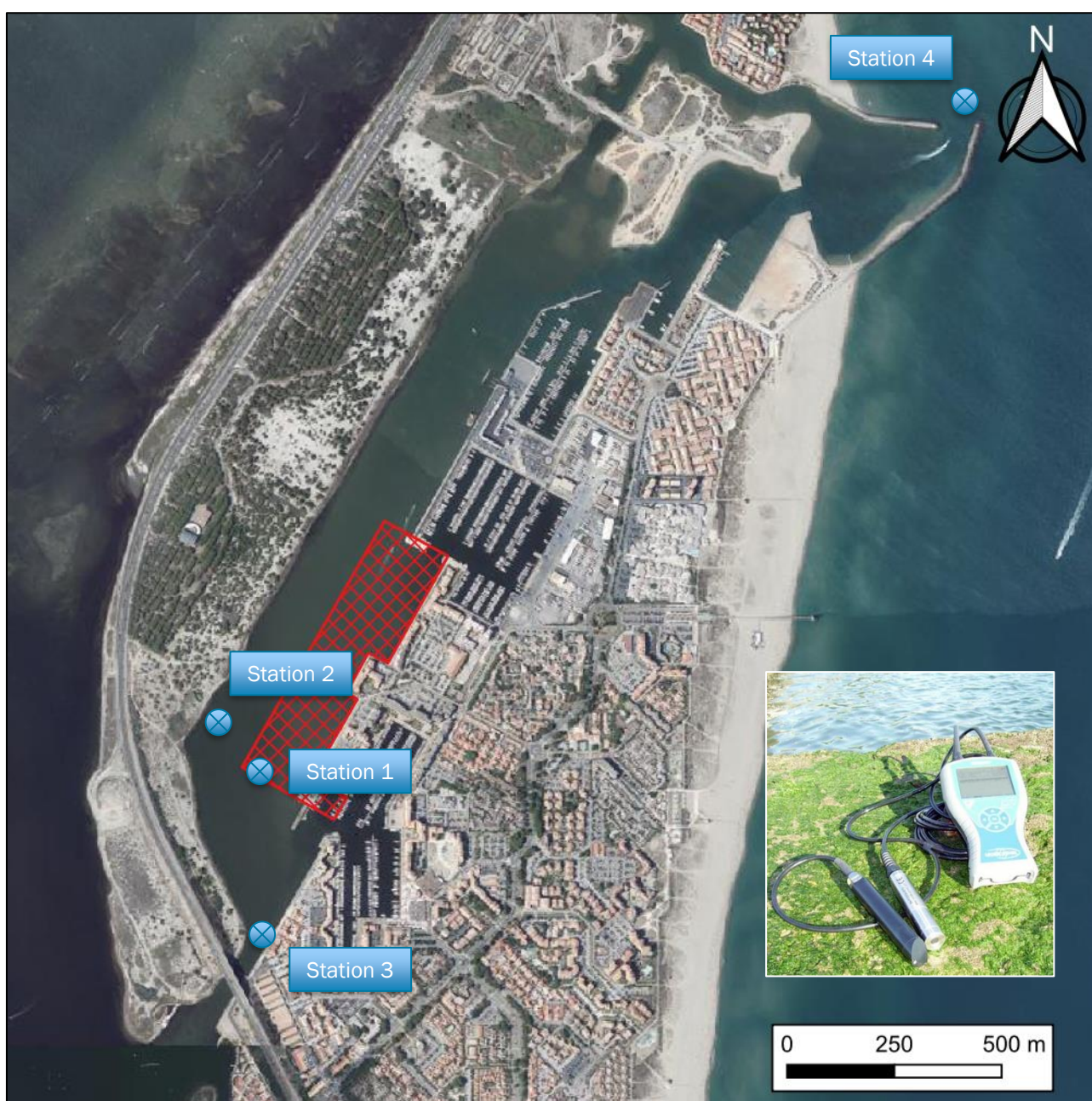
Figure 8 : Localisation des stations de suivi de la turbidité – Les stations 1 et 2 sont déplacées au fur et à mesure de la progression des travaux. Exemple de sonde turbidimètre pour mesurer in-situ la turbidité de l'eau.
